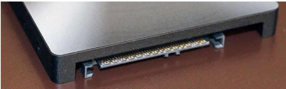
Imagen de un prototipo de disco duro con interfaz SATA Express . [18]
