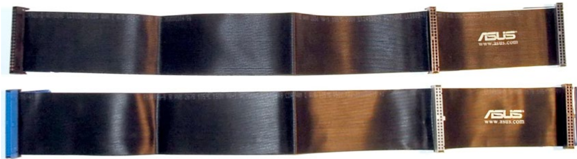
Des- Cables IDE. El de arriba tiene 40 hilos y el de abajo 80 hilos
