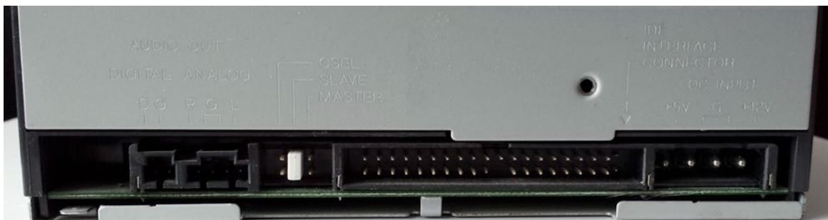
Regrabadora de DVD con conexión PATA seleccionada como esclava.
