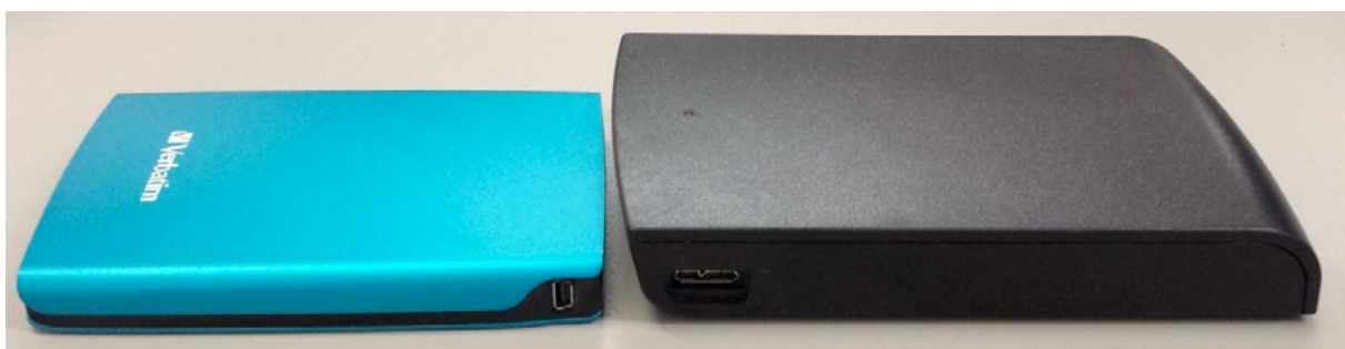
Detalle de la conexión de dos discos duros USB. A la izquierda un disco duro USB 2.0 y a la derecha un USB3.0 acerca a los 1,6 GB/s en lectura y 1,35 GB/s en escritura.
