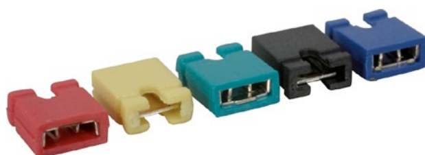
Jumpers o puentes de configuración de discos duros y otros elementos de la placa base. [7]
