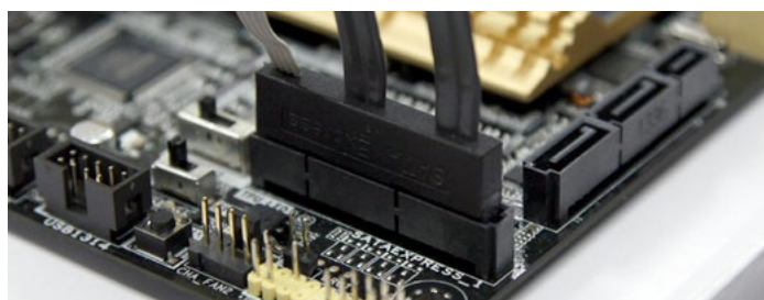
Detalle de un cable SATA Express conectado a la placa base. [20]
