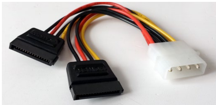
Adaptador de conector Molex de 4 pines (blanco) a dos conectores de alimentación SATA de 15 pines.
