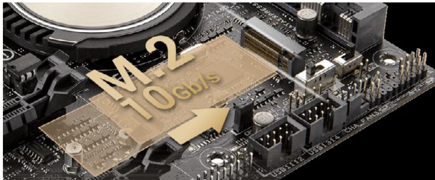
Detalle del conector M.2 SATA de una placa base ASUS modelo Z97A. [17]
