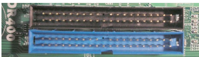
Detalle de los conectores IDE de una placa base. [5]
