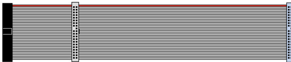
Cable IDE con tres conectores (el de la derecha va conectado a la placa base). [6]
