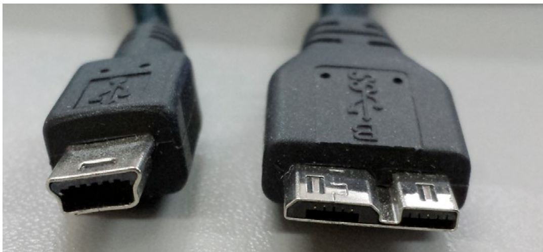
Conectores de disco duro USB. A la izquierda un conector USB Mini-B macho (USB 2.0), y a la derecha un conector USB Micro-B macho (USB 3.0).
