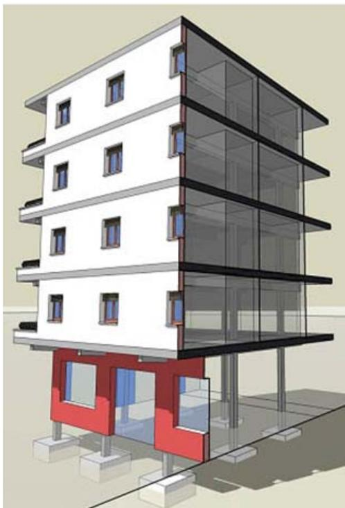
Figura 14 Modelo del tipo MC31 - pre según el Índice de Vulnerabilidad
