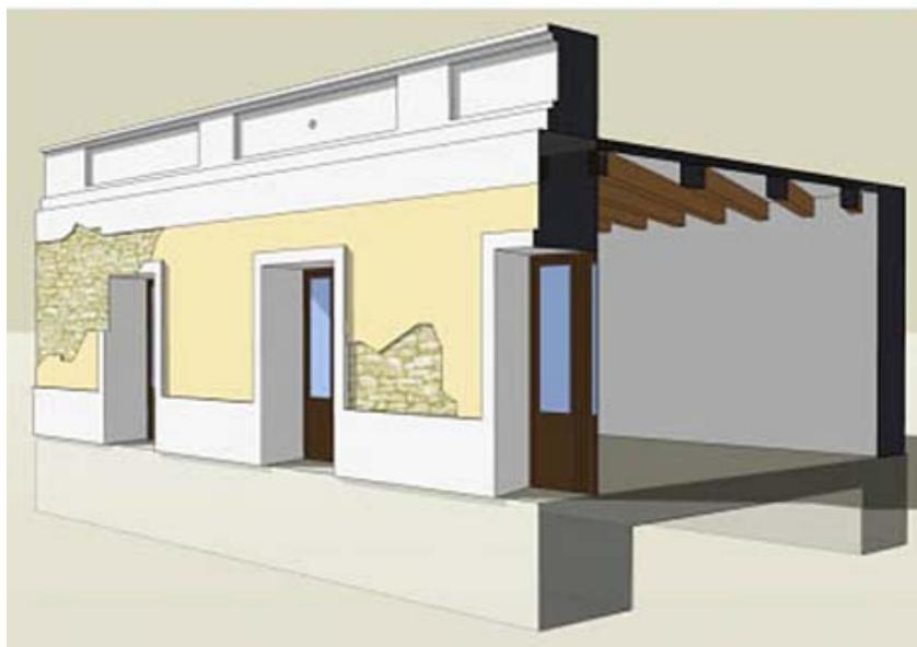
Figura 11 Modelo del tipo M11 según el Índice de Vulnerabilidad
