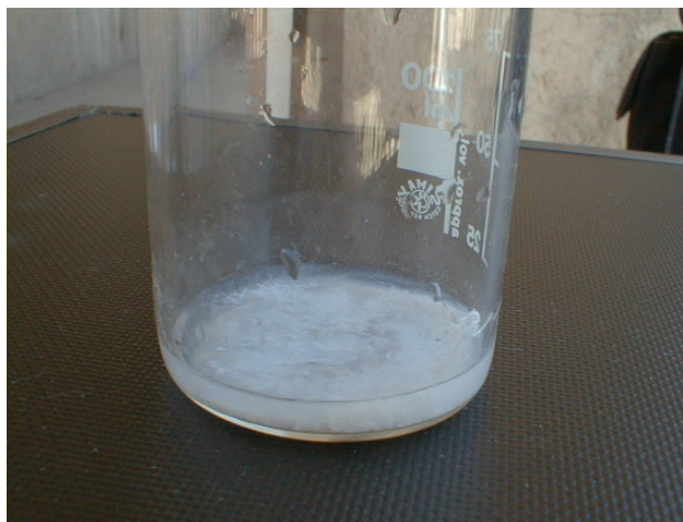
Figura 9.4.2.1.b Precipitado de cloruro de plata tras un ensayo cualitativo.
