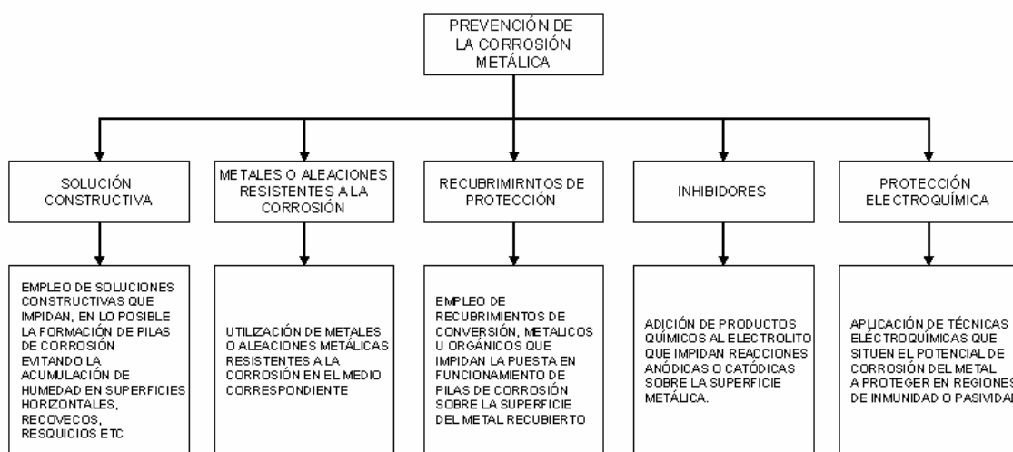
Figura 10.1 Resumen del las técnicas de prevención de la corrosión metálica
