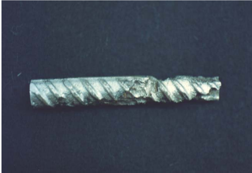
Figura 2.3.b Formación de picaduras en una armadura. En algunos tramos la sección se había reducido a la mitad.
