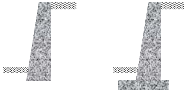
Croquis 06 Muros de gravedad
