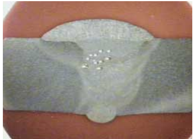
2.7 Exceso de penetración (descuelgue)
