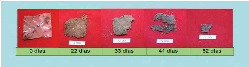
Figura 4 Evolución de probetas con almidón 100%.
