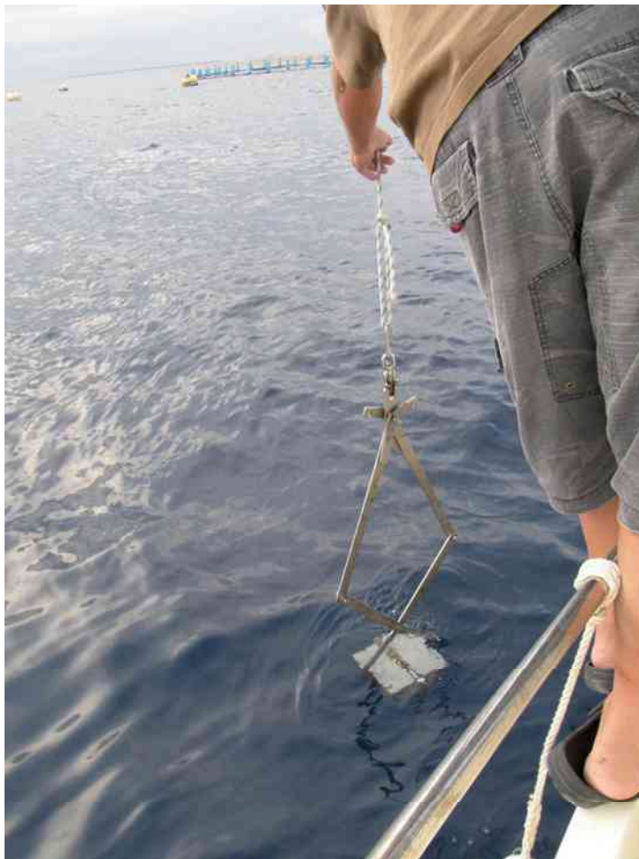
Foto 1 Toma de muestras de sedimento con draga tipo Van-Veen.
