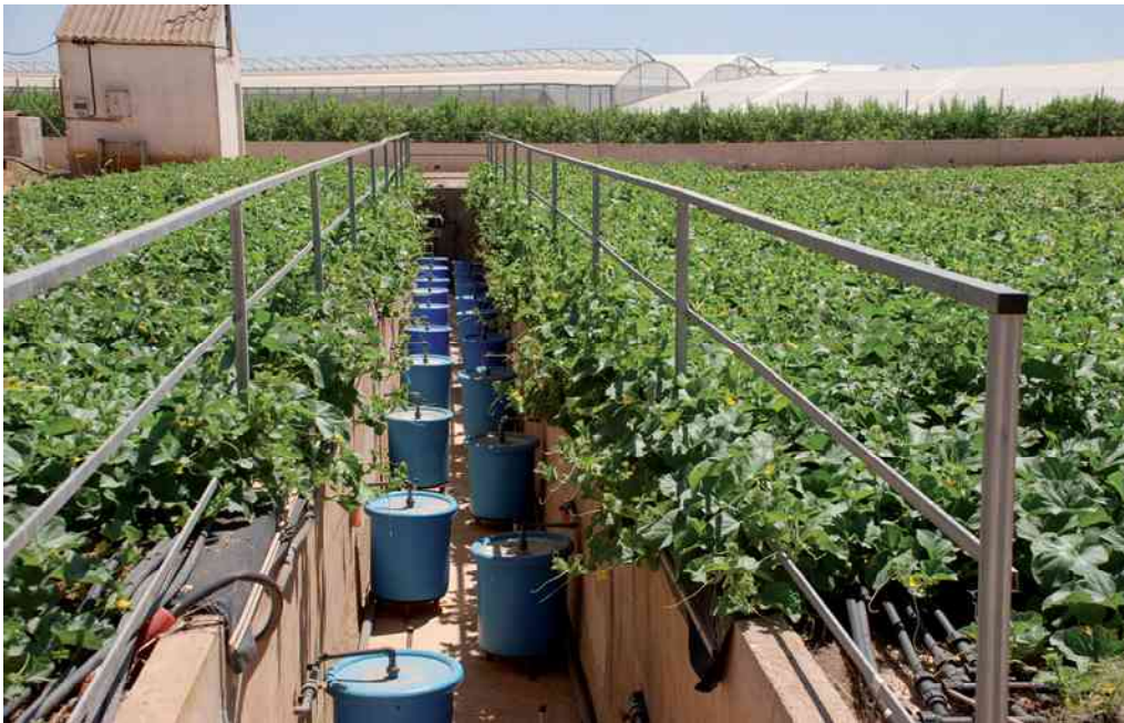
Figura 1 Lisímetros al aire libre en la época del cultivo de melón
