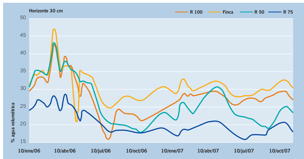
Figura 4 Curvas de la evolución de los valores medios del contenido en agua volumétrica (%) de cada tratamiento a 30 cm de profundidad.
