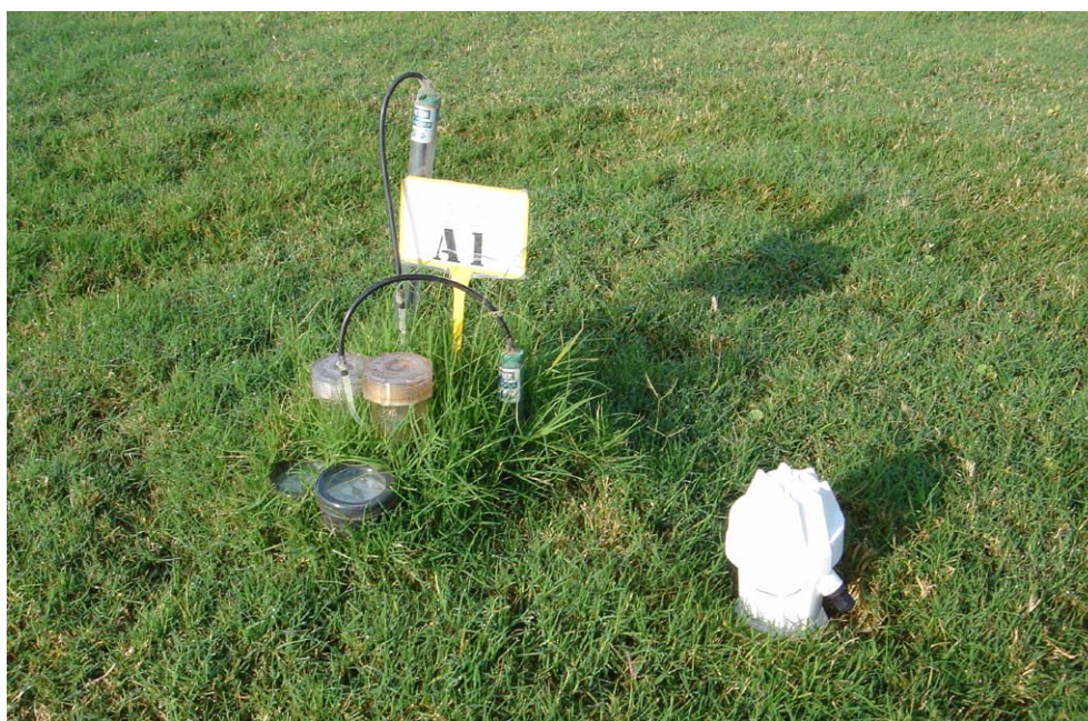
Instrumentos para el control de la humedad: tensiómetros, sondas de succión y dispositivo para la monitorización continua de la humedad del suelo FDR.
