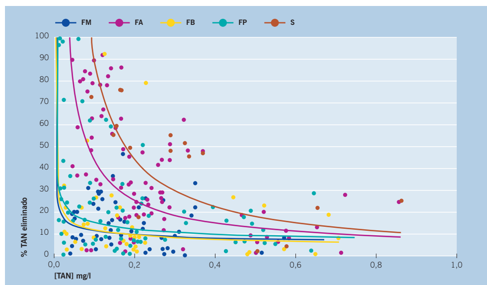
Figura 3 Relación entre el porcentaje de amoniaco eliminado (% TAN eliminado) en función de la concentración de TAN a la entrada de los distintos tipos de filtros (FM = Mecánico de esponja; FA = Arena; FB = Mecánico sumergido; FP = Biológico sumergido; S = Skimmer).
