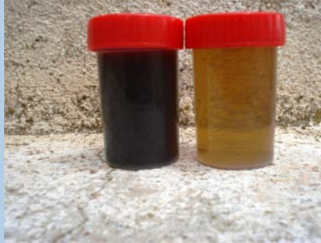
Aspecto comparativo del purín bruto (izq) antes de procesar y aspecto del efluente después del humedal artificial (dcha).
