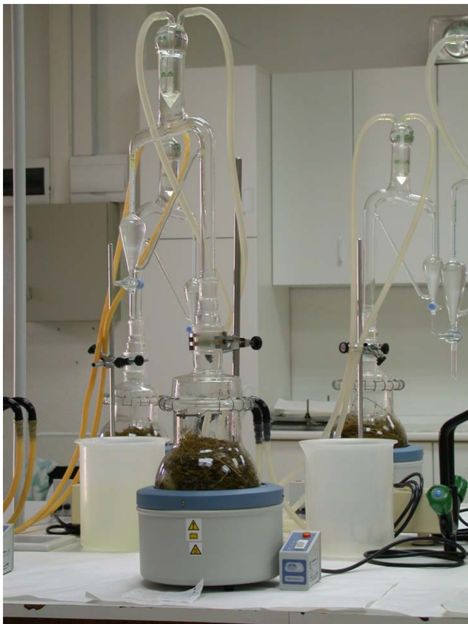
Fig. II-6. Sistema Clevenger empleado en la extracción del aceite esencial.
