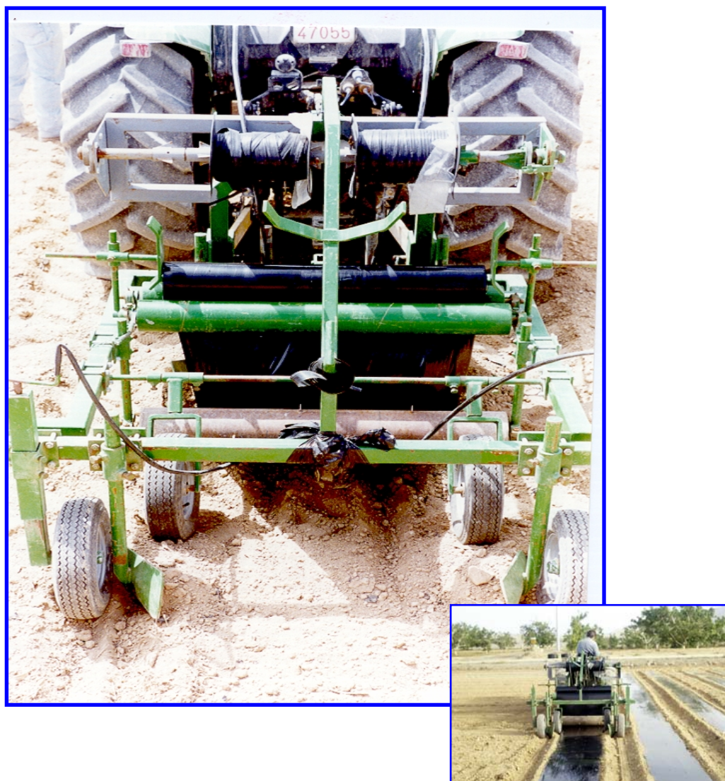
Fig. II-3. Apero utilizado para la colocación de tuberías y plásticos.
