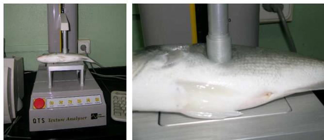
Figura 8: Medida de textura mediante compresión.
