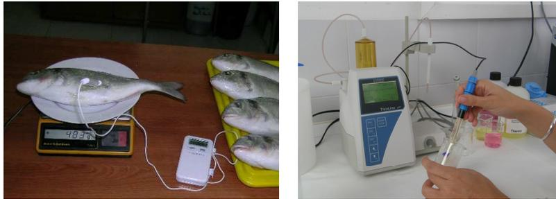
Figura 7: Medidas de pH del músculo del pescado colocando los electrodos directamente dentro de la carne del pez (izquierda) y en una suspensión de músculo en agua destilada (derecha).
